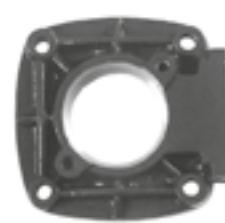
TAPA DE COMPRESOR DE AIRE CUMMINS
